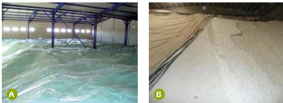
2. ábra: Az ömlesztett áru helyes tárolása (A), ill. a helytelen takarás következtében 30 cm mélységben elporosodott műtrágya (B).
