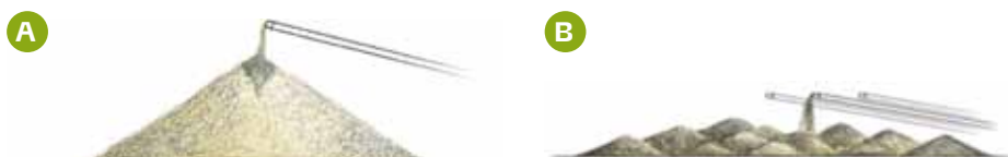
1. ábra: Ömlesztett műtrágyák helytelen (A) és helyes (B) tárolása.
